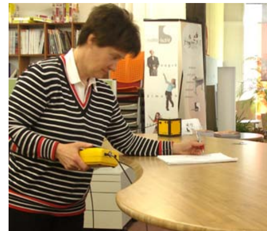
Messgerät: Handelektrode Typ 30 S + Multimeter Fluke 183
